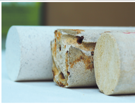
اختبار الأنبوبة الدودية للعينة الأساسية.
